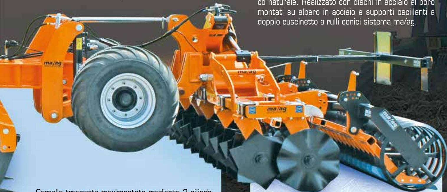
Carrello trasporto movimentato mediante 2 cilindri idraulici dotati di dispositivo di sicurezza con valvola di blocco. Ruote tipo maggiorato, semiassi ad 8 fori.
