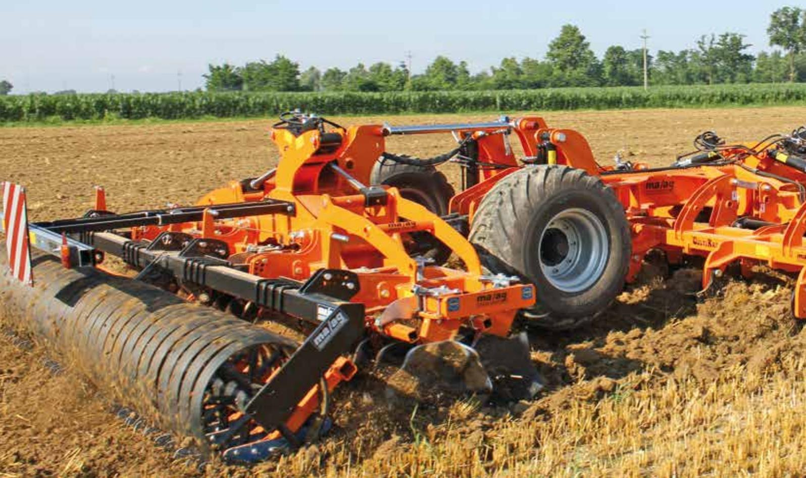
Attacco terzo punto posteriore, oscillante per applicazione kit frantumatore posteriore o altro.
