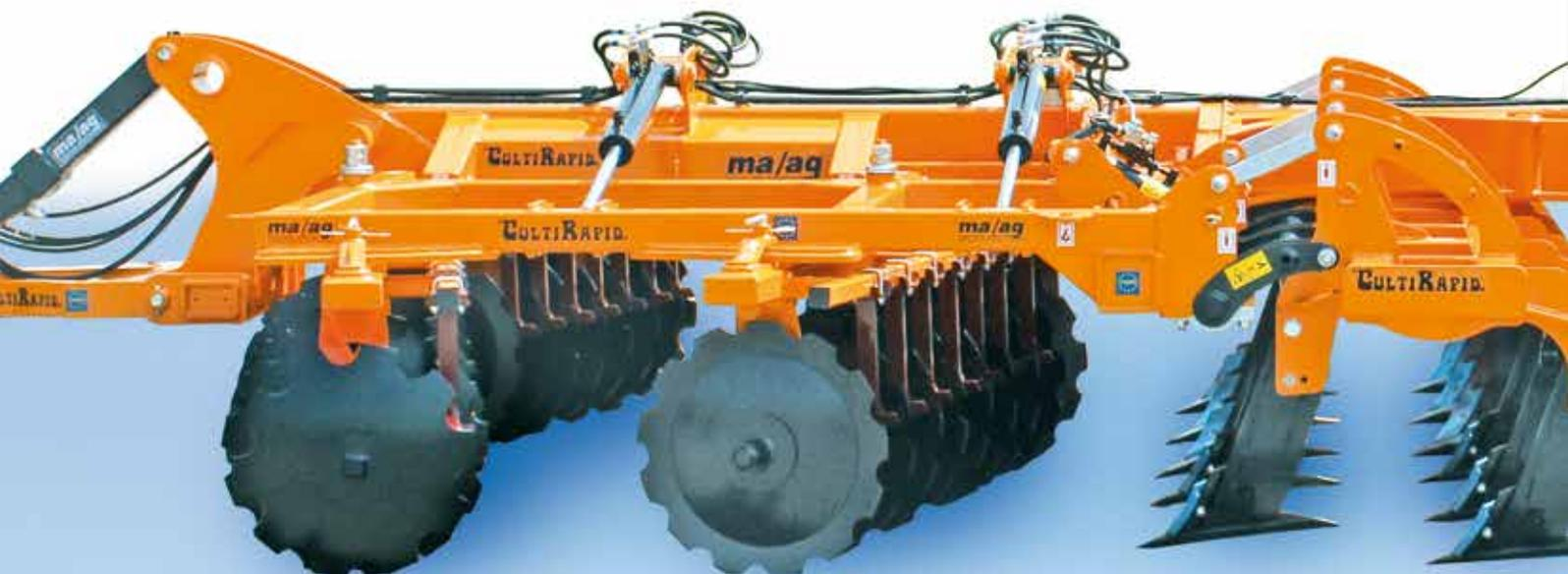
Doppia dischiera a dischi bombati dentati. Realizzata con dischi in acciaio al boro montati su albero in acciaio e supporti oscillanti a doppio cuscinetto a rulli conici sistema ma/ag. Le dischiere sono disposte a rombo sistema ma/ag brevettato. Regolazione angolo di lavoro manuale in differenti posizioni.
