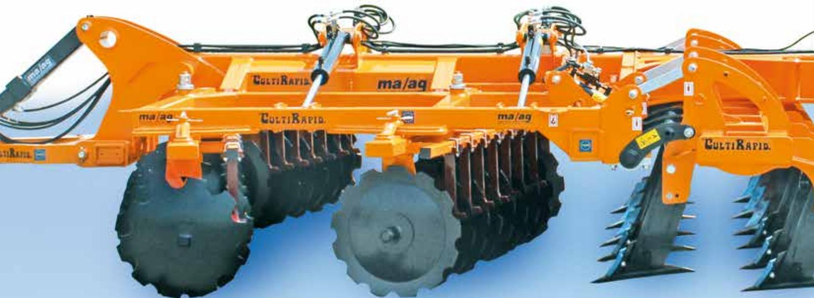
Doua randuri de discuri bombate, dintate, realizate din discuri din otel cu bor, montate pe un ax din otel cu suportii oscilanti cu doi rulmenti cu role conice - sistem ma/ag. Sectiunea de discuri este aranjata in forma de “romb”, sistem patentat ma/ag. Reglare manuala a inclinarii in diverse pozitii.
