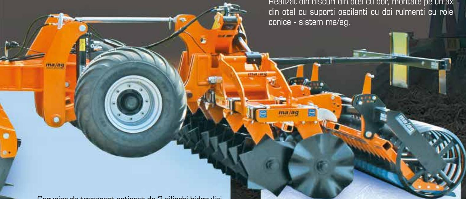
Carucior de transport actionat de 2 cilindri hidraulici dotati cu dispozitiv de **siguranta cu supapa** de blocare. Roti majorate, semiaxe cu 8 gauri.
