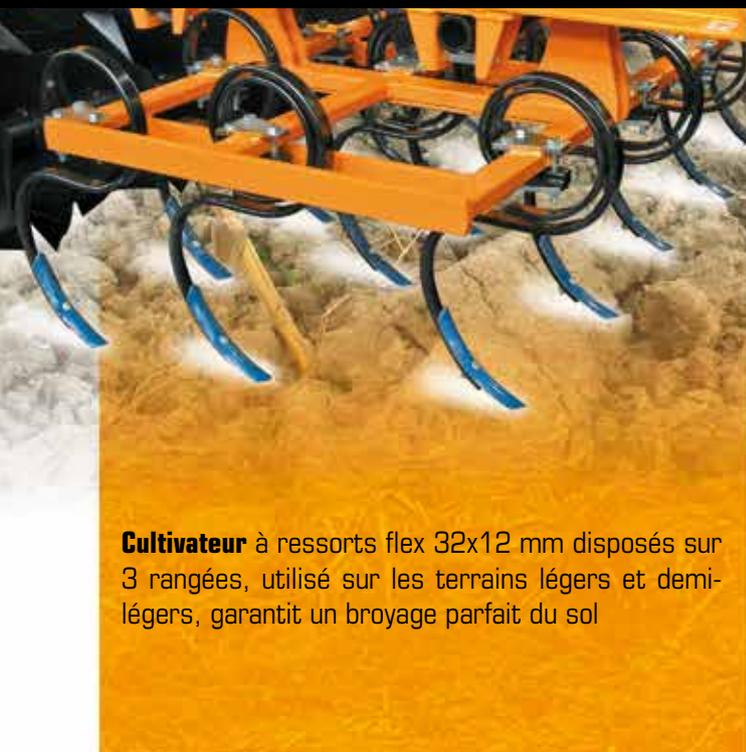
**Cultivateur** à ressorts flex 32x12 mm disposés sur 3 rangées, utilisé sur les terrains légers et demi-légers, garantit un broyage parfait du sol
