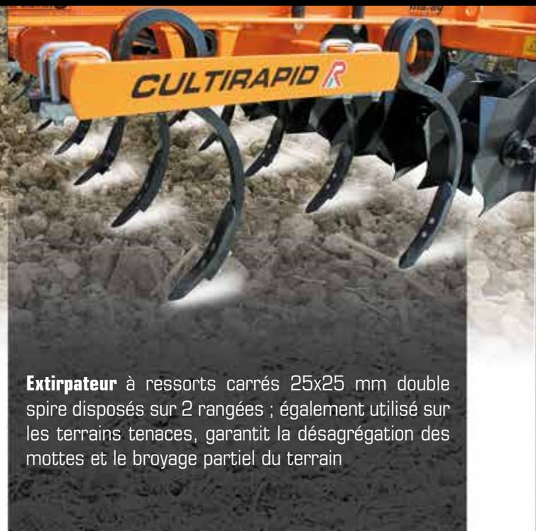
**Extirpateur** à ressorts carrés 25x25 mm double spire disposés sur 2 rangées ; également utilisé sur les terrains tenaces, garantit la désagrégation des mottes et le broyage partiel du terrain
