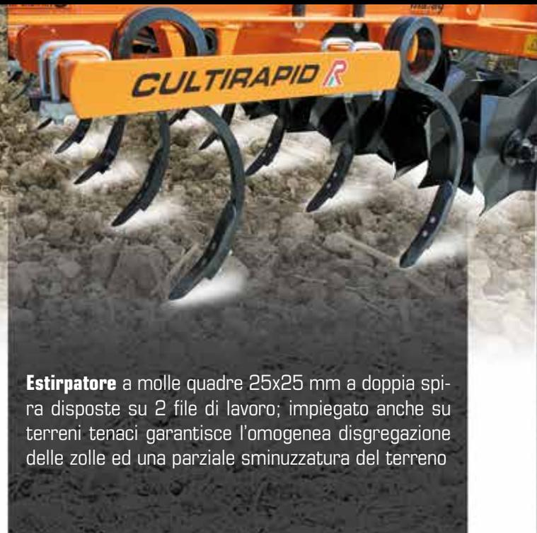
**Estirpatore** a molle quadre 25x25 mm a doppia spirale disposte su 2 file di lavoro; impiegato anche su terreni tenaci garantisce l'omogenea disgregazione delle zolle ed una parziale sminuzzatura del terreno
