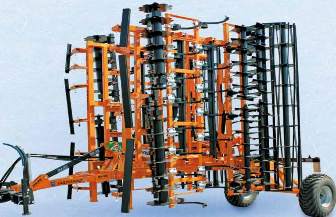
**TELAIO PIEGHEVOLE PER LA CIRCOLAZIONE STRADALE INGOMBRO IN TRASPORTO 2,55 m**
