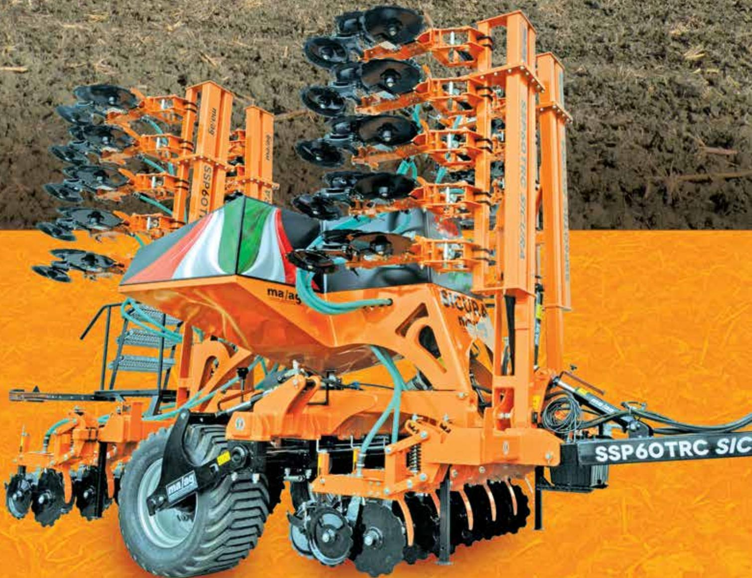
**CHÂSSIS PLIANT POUR LA CIRCULATION SUR ROUTE GABARIT TRANSPORT 2,55 M**
